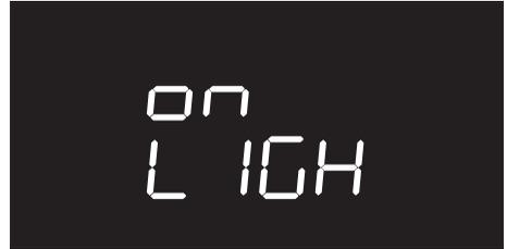
Para evitar que o aparelho desligue a lâmpada automaticamente após um minuto, defina este modo para OFF.
